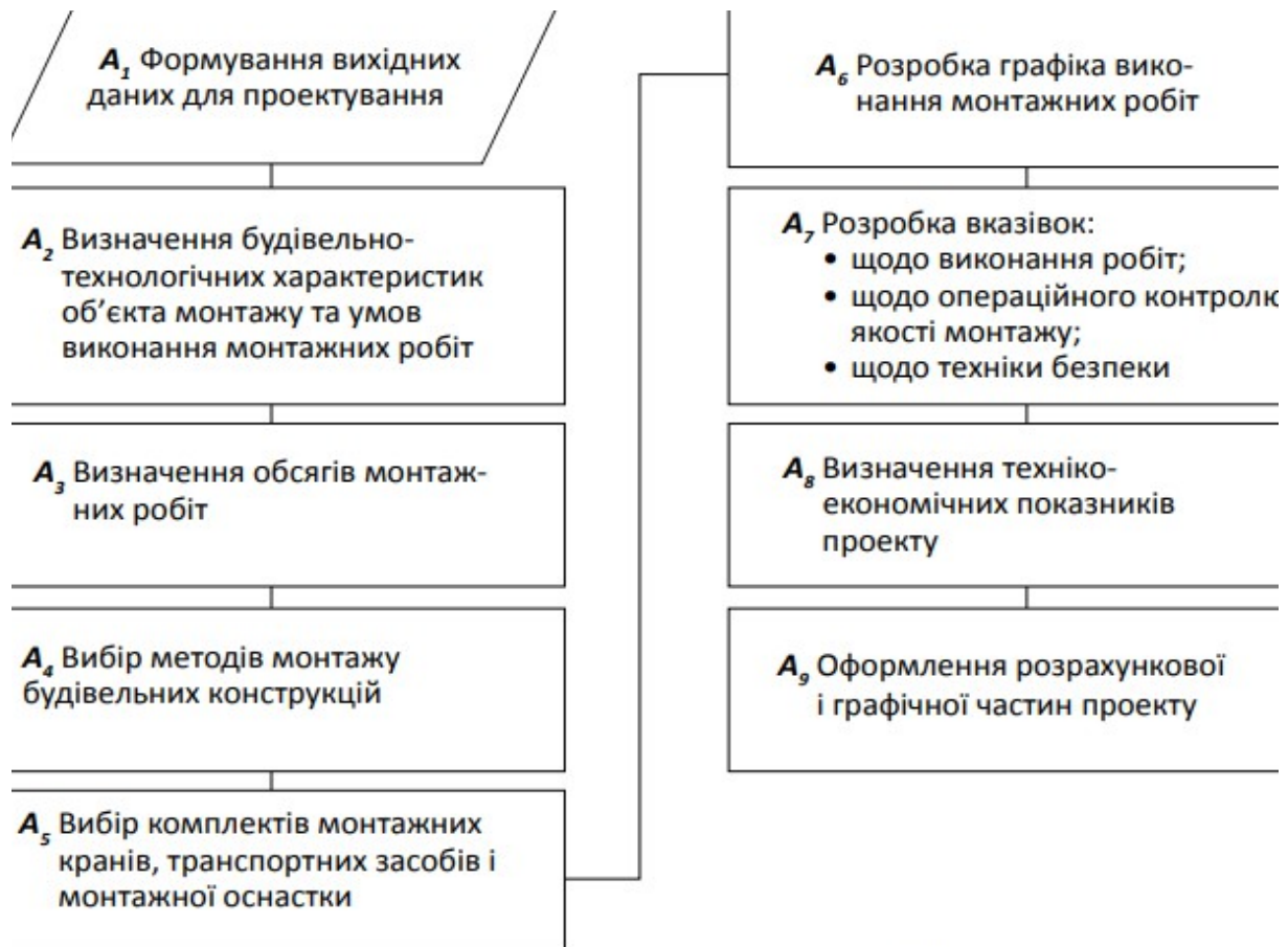
Рис. 1. Загальна схема методики проектування технології монтажу будівельних конструкцій
