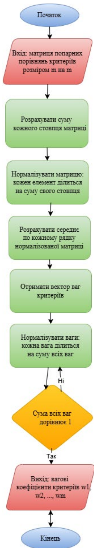
Рисунок 3.7 – Алгоритм модуля розрахунку ваг методом АНП
