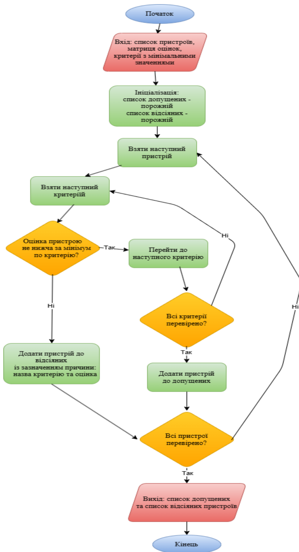
Рисунок 3.6 – Алгоритм модуля відсіву неперспективних варіантів
