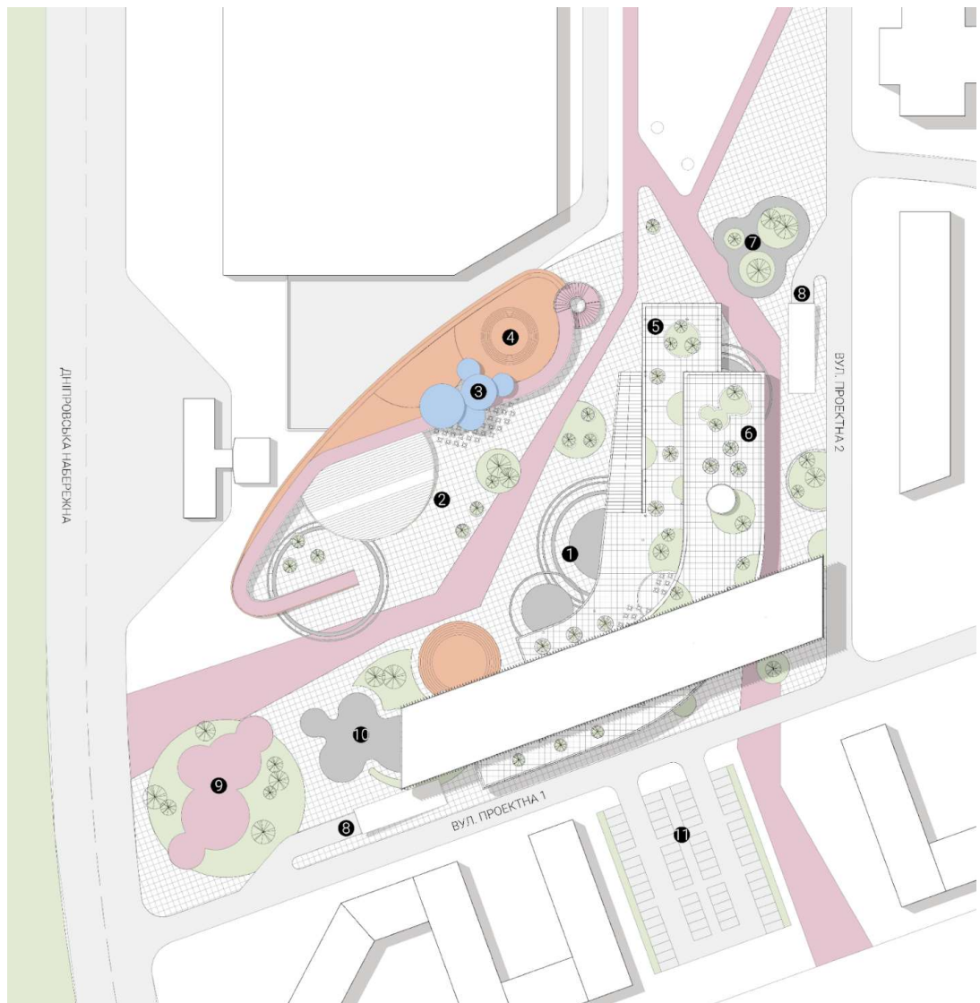
Рис. 3.2 Схема генерального плану: 1 – променада; 2 – амфітеатр; 3 – споруда навісу 4 – споруда з кафе на 100 чоловік та рекреаційним простором зверху; 5 - тераса 2-го поверху; 6 - тераса 3-го поверху; 7 - острівець рекреації; 8 - заїзд у підземний паркінг; 9 - виставковий простір; 10 - скейт пул; 11 - парковка для відвідувачів та проектованої офісної забудови.
