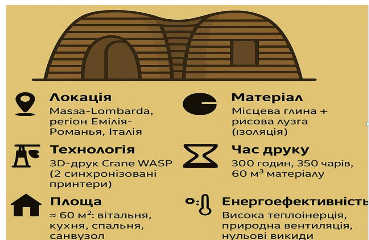
Рис. 1.6. Житловий 3D-друкований будинок TECLA в Масса-Ломбарда, Італія
