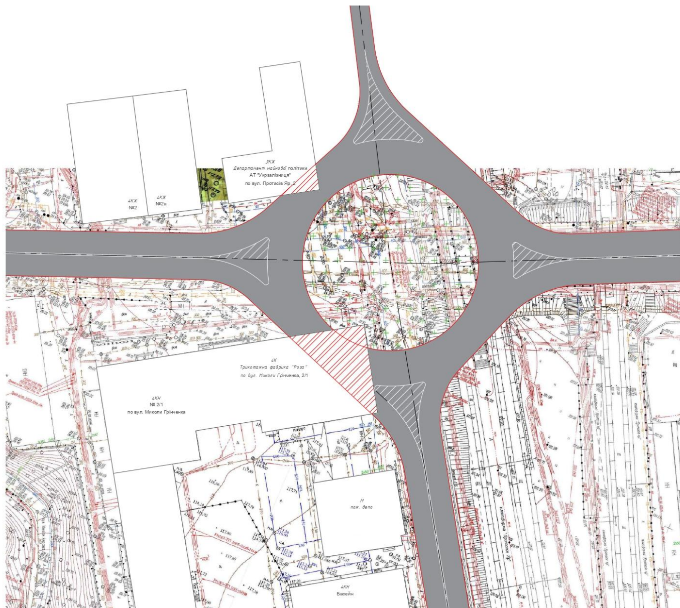
Рис. 2.15.2. Проектно планувальне рішення саморегульованого кільцевого перетину, та зонами впливу кільця на сусідні будівлі
