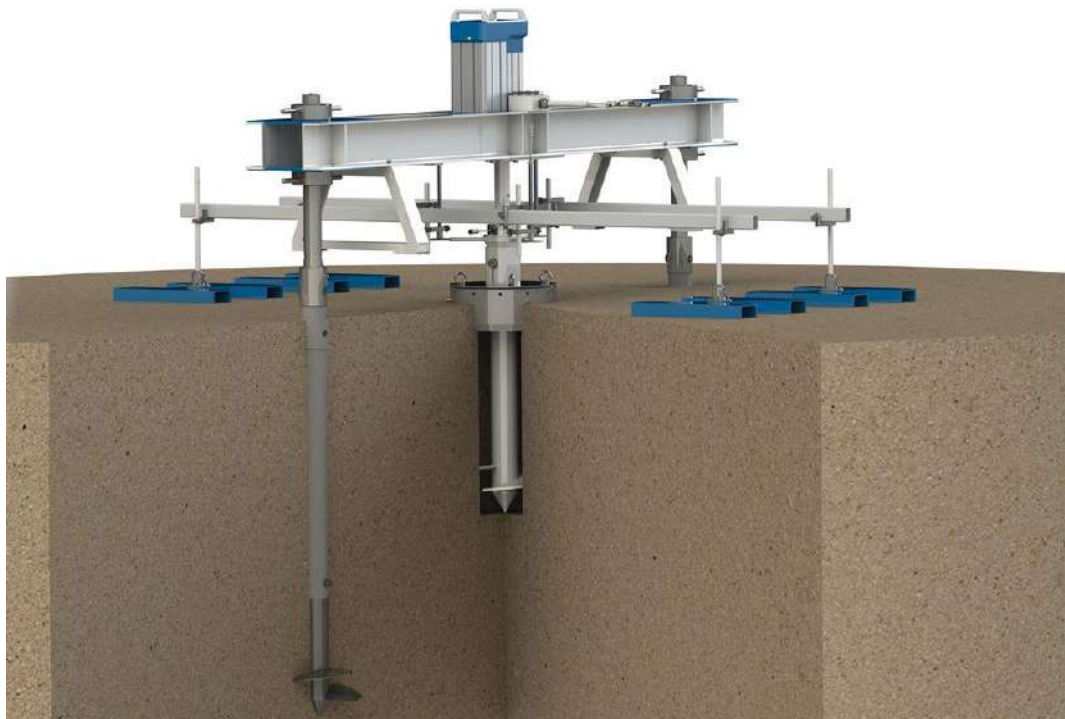
Схема випробовування ґрунту гвинтовим штампом
