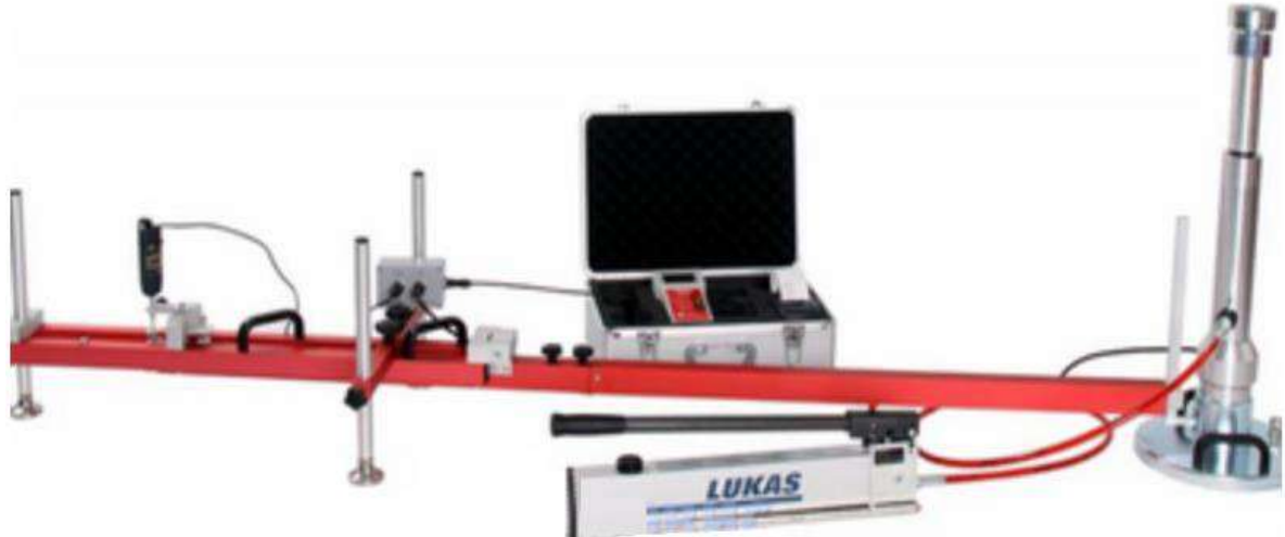
Штампова установка статичного навантаження "HMP PDG" від компанії «HMP Magdeburger Prüfgeratebau GmbH»
