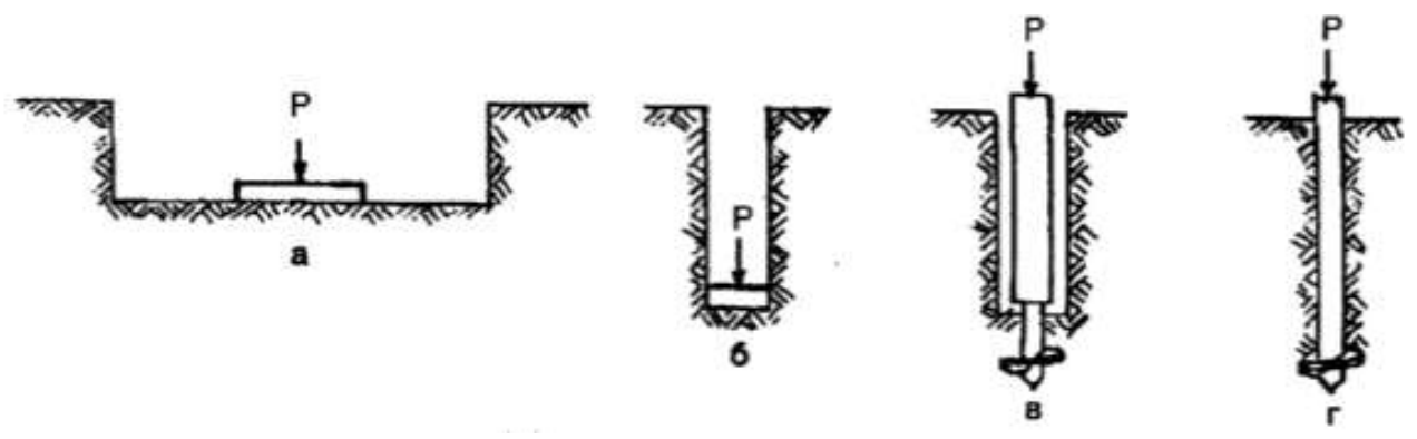
Схеми випробувань ґрунту штампами для визначення характеристик деформованості
