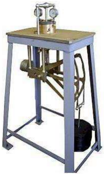
Компресійний прилад КПП-1М з одометром: а – загальний вигляд приладу; б – принципова схема одометру; 1 – зразок ґрунту; 2 – робоче кільце; 3 – перфорований штамп; 4 – піддон з ємністю для води і перфорованим вкладишем під кільце; 5 – механізм вертикального навантаження; 6 – циліндрична обойма; 7 – індикатор для вимірювання вертикальних деформацій зразка ґрунту
