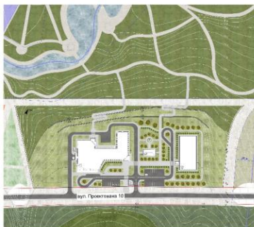
Генеральний план М 1:200 Експлікація: 1. Проектна будівля 2. Спортивний комплекс 3. Пост спортивний 4. Автомобільна стоянка 5. Площада для проведення тренувань 6. Зона рекреації 7. Зона озеленення при харч. блоці 8. Ситтєвий блок
