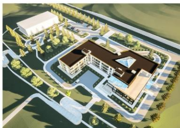
Генеральний план М 1:200 Експлікація: 1. Проектна будівля 2. Спортивний комплекс 3. Пост спортивний 4. Автомобільна стоянка 5. Площада для проведення тренувань 6. Зона рекреації 7. Зона озеленення при харч. блоці 8. Ситтєвий блок
