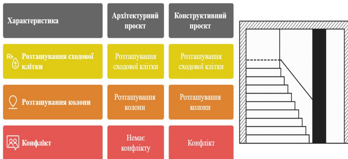
Рис. 4.3. Приклад неточності у проєктній документації, пов'язаної з розташуванням сходової клітки та колони (розроблено автором на основі [63])
