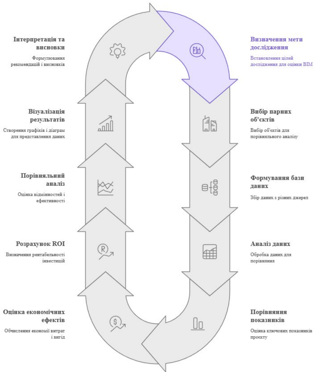
Рис. 2.9. Етапи порівняльного аналізу ефективності будівельних проєктів Pre-BIM та BIM-assisted (розроблено автором на основі [72])
