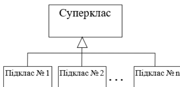
Рис. 2.2. Система позначень UML []
