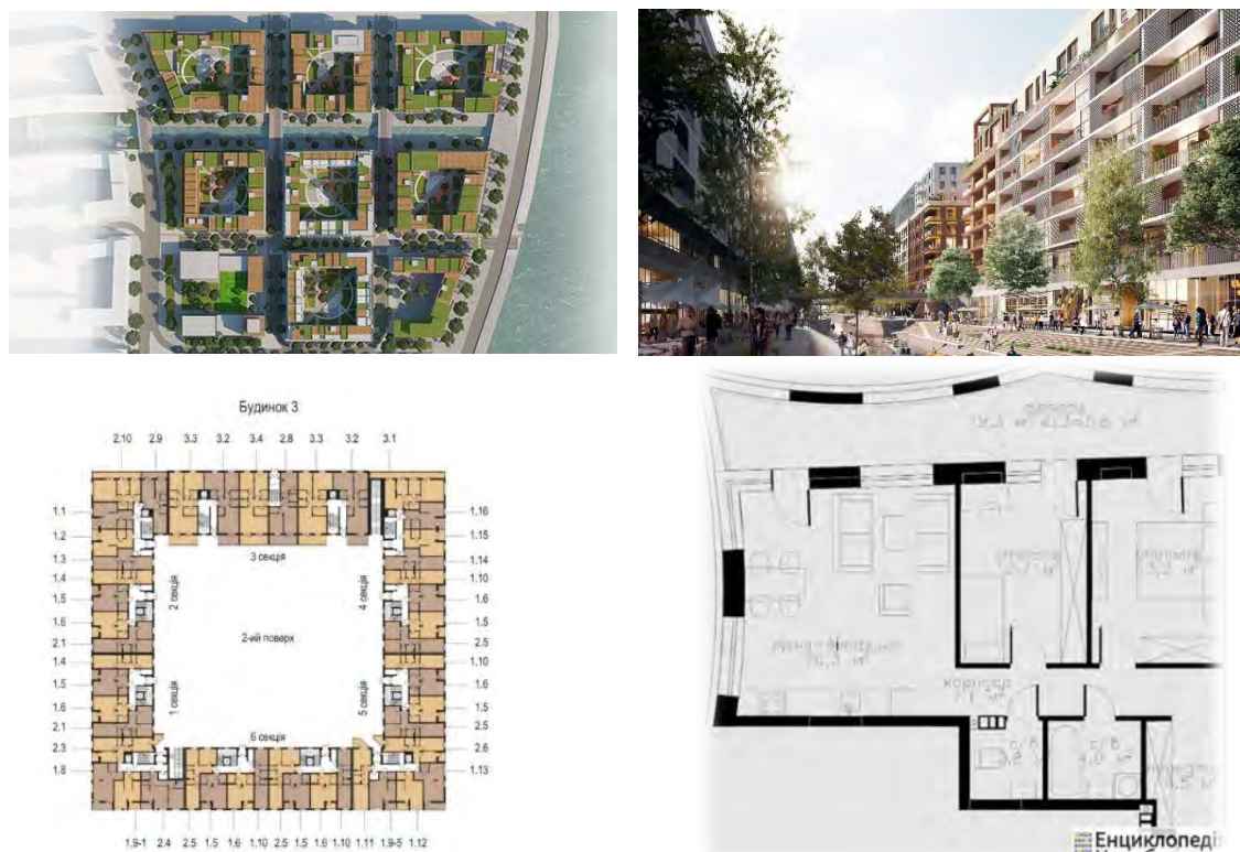
Рис. 2.19. Комплексне архітектурно-планувальне рішення району Rybalsky: аерофотофіксація та генплан забудови, візуалізація пішохідного бульвару, план типового поверху-секції та приклад планування двокімнатної квартири [7]
