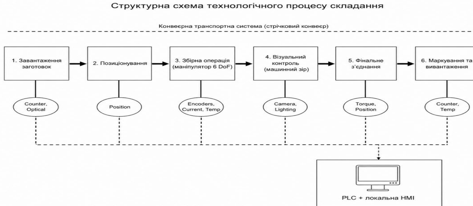
Рисунок 4 — Структурна схема технологічного процесу складання (6 станцій)
