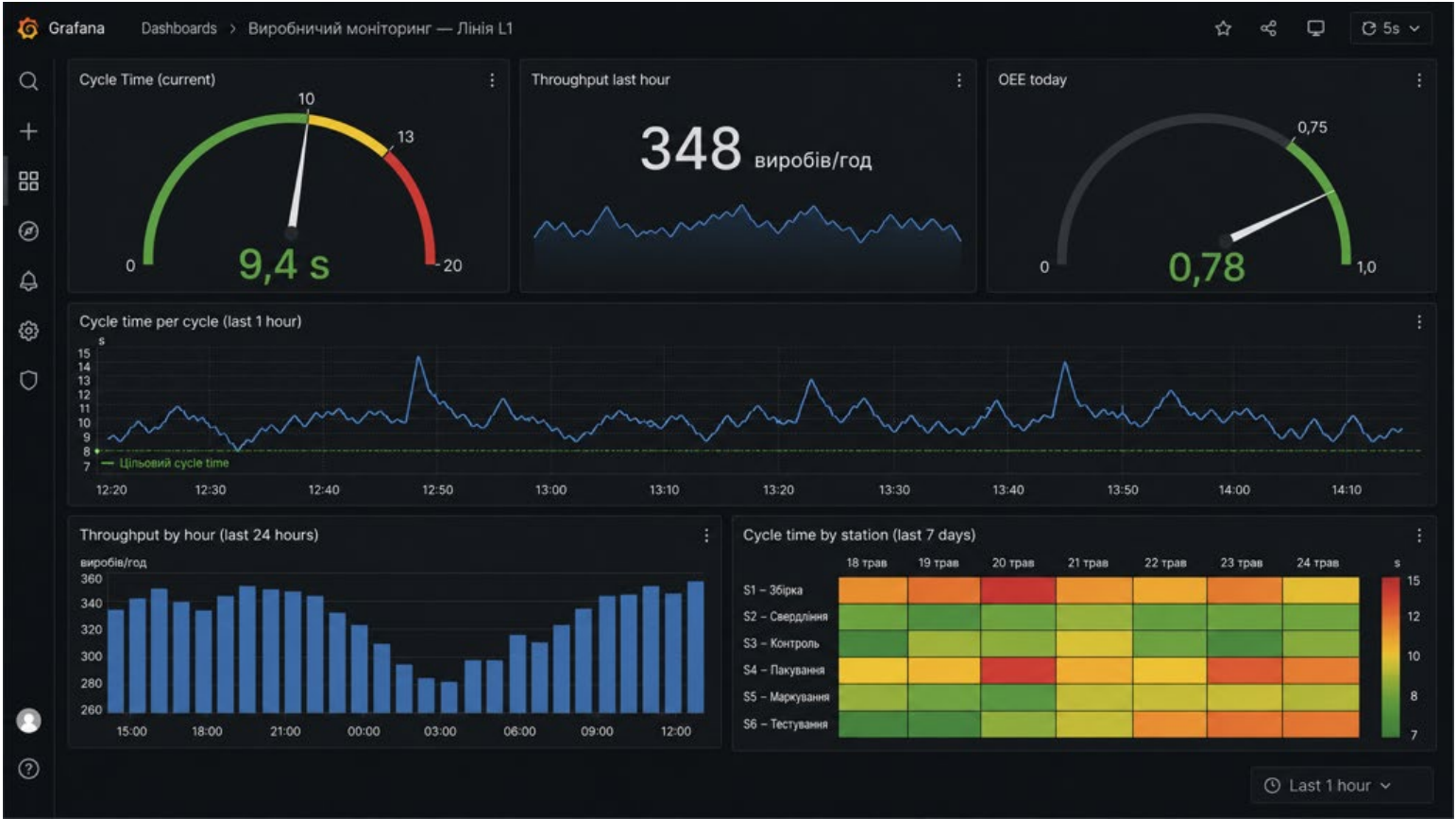
Рисунок 6 — Дашборд «Виробничий моніторинг — Лінія L1»: cycle time, throughput, OEE
