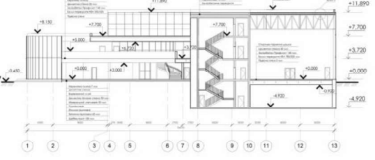
Детальний розріз по стіні 3-3, М 1:200
