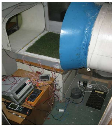
Рис. 4.24 – Фізична модель екстенсивної «зеленої покрівлі» (аеродинамічна труба)
