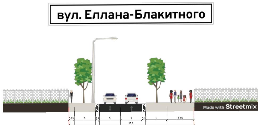
Рис 1.6 Поперечний профіль вул. Еллана-Блакитного (існуючий)
