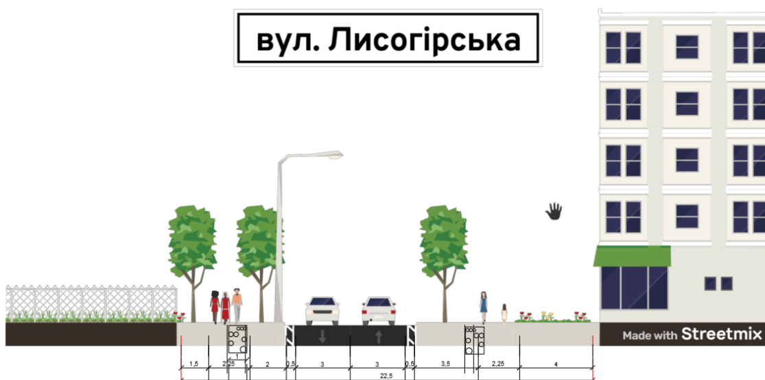
Рис 2.2 Поперечний профіль вул. Лисогірська (3) (проектний)
