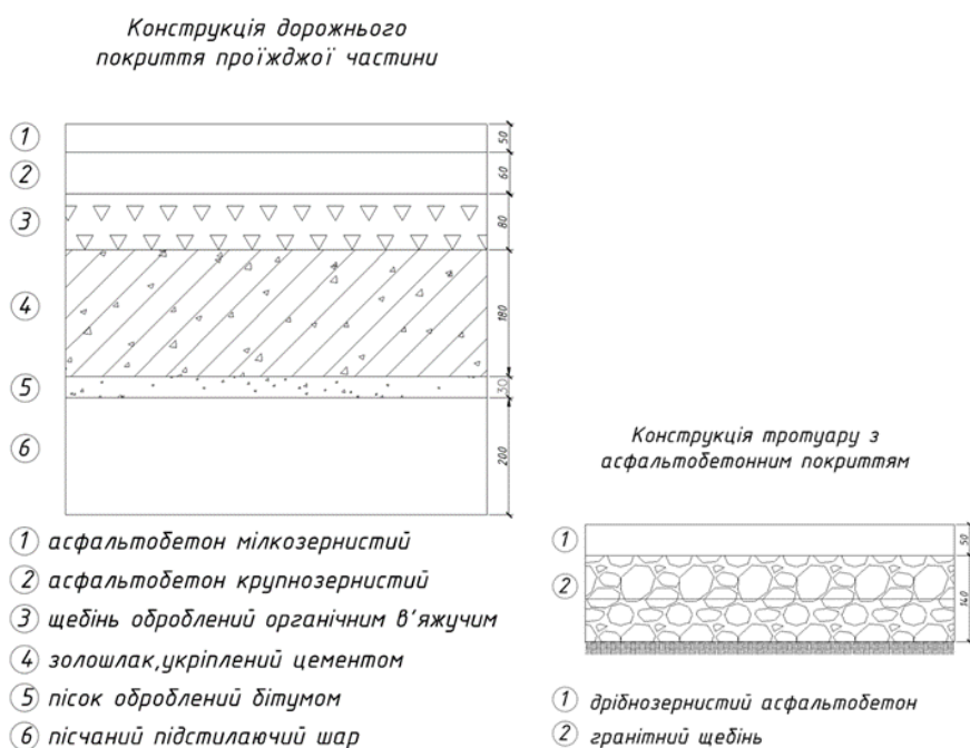
Рис. 3.1 Розріз конструкції дорожнього одягу
