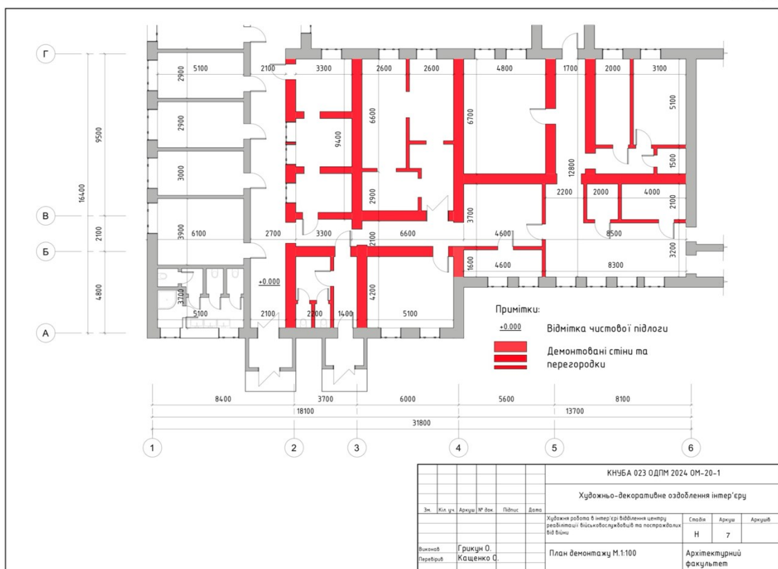
Рис.16.1 зображення плану демонтажу стін
