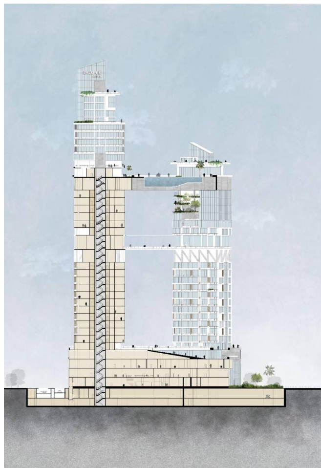
Рис. 2.3.2. Вертикальний розріз об'єкта: сегментація на функціональні яруси та морфологічна структура «вертикального міста» [71].
