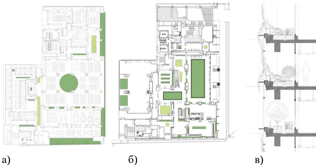
Рис.2.1.2. Архітектурно-планувальна організація вертикальної ферми «Pasona Urban Farm» у м. Токіо (арх. бюро Kono Designs): а) план першого поверху з демонстрацією функціонального зонування та вхідної групи.; б) інтер'єр головного лобі з візуалізацією «еко-паузи» та фрагмент плану підвального поверху (рівень -1); в) конструктивний розріз та деталізація секції балкону з інтегрованими агросистемами [45; 46].
