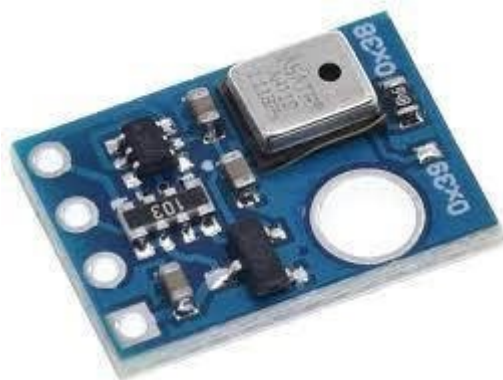
Рисунок 2.4 – Цифровий датчик температури та вологості АНТ10[21]
