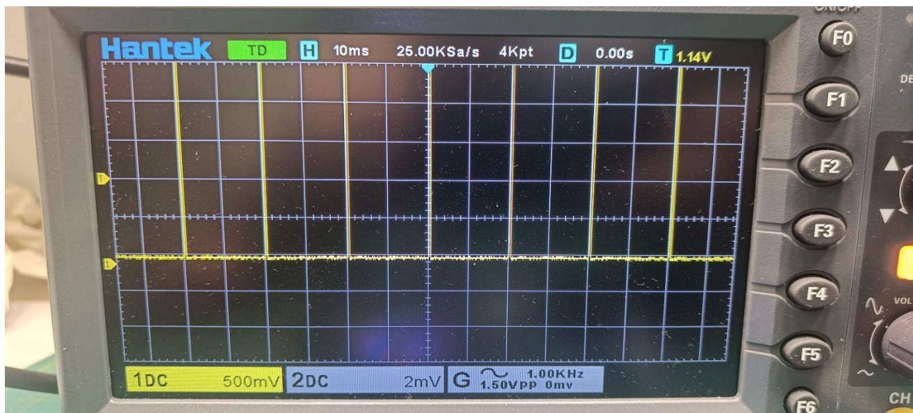
Рисунок 3.25 – Вигляд сигналу при подачі 527 PWM
