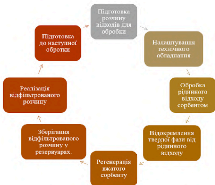
Рисунок 5.3 – Схема сорбційного методу переробки радіоактивних відходів
