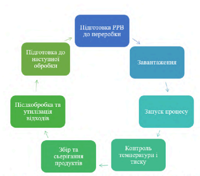
Рисунок 5.2 – Схема термічного методу переробки радіоактивних відходів
