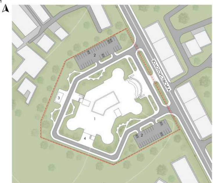
ГЕНЕРАЛЬНИЙ ПЛАН М 1:1500 ЕКСПЛИКАЦІЯ ДО ГЕНЕРАЛЬНОГО ПЛАНУ: 1. Об'єкт проектування 2. Парковий майданчик 3. Вихід з укриття 4. Зона розташування УМОВНІ ПОЗНАЧЕННЯ ДО ГЕНЕРАЛЬНОГО ПЛАНУ: - Озеленення - Міжкілометрові лінії - Чорна лінія - Зелена зона
