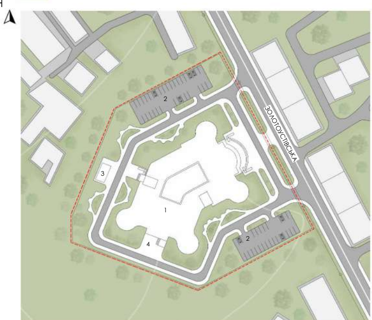
ГЕНЕРАЛЬНИЙ ПЛАН М 1:1500 ЕКСПЛИКАЦІЯ ДО ГЕНЕРАЛЬНОГО ПЛАНУ: 1. Об'єкт проектування 2. Парковий майданчик 3. Вихід з території 4. Зона озеленення УМОВНІ ПОЗНАЧЕННЯ ДО ГЕНЕРАЛЬНОГО ПЛАНУ: - Озеленення - Місця стоянок - Чорна лінія - Зелена зона
