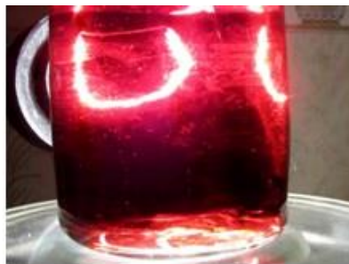
Рис. 3.31. Окиснення феруму (II) гідроксиду до феруму (III) гідроксиду і розчинення його в хлоридній кислоті з утворенням комплексу
