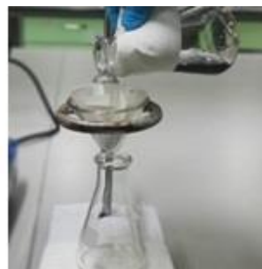
Рис. 3.30. Отримання Феруму (II) гідроксиду з розчину амоніаку та солі Феруму
