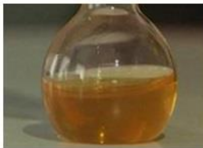
Рис. 3.32. Розчин хелату феруму (III) з сульфосаліциловою кислотою до титрування та після титрування його трилоном Б
