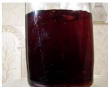
Рис. 3.32. Розчин хелату феруму (III) з сульфосаліциловою кислотою до титрування та після титрування його трилоном Б
