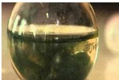
Рис. 3.30. Отримання Феруму (II) гідроксиду з розчину амоніаку та солі Феруму
