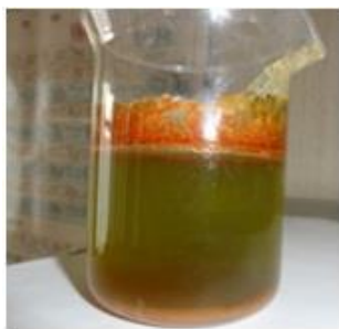
Рис. 3.31. Окиснення феруму (II) гідроксиду до феруму (III) гідроксиду і розчинення його в хлоридній кислоті з утворенням комплексу
