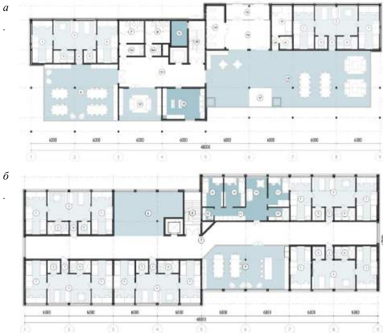
Рис. 3.1.8. Гуртожиток типу Г2: а. - План I поверху; б. - План типового поверху.
