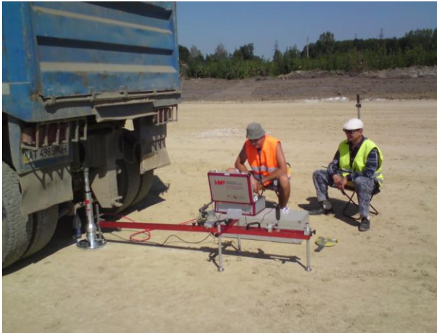
Рис. 1. Штамп НМР PDG-SD, зібраний в повній комплектації
