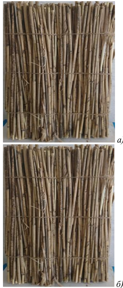
Рис. 1. Модельні зразки теплоізоляційних матів з очерету: а – необроблений; б – оброблений модифікованим покривельним просочувальним розчином «Skela-i».
