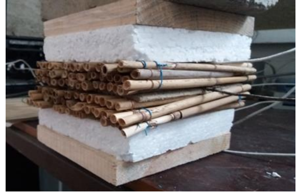
Рис. 3. Процес визначення теплопровідності зразка мату, виготовленого з очерету під дією нагрівача.
