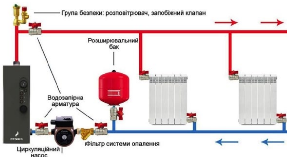
Рис. 3.1 Принципова схема обв'язки котла
