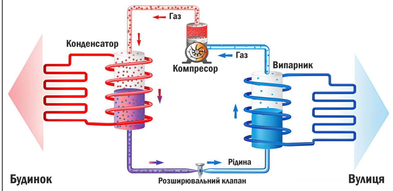
Рис. 3.7 Принцип роботи теплового насоса
