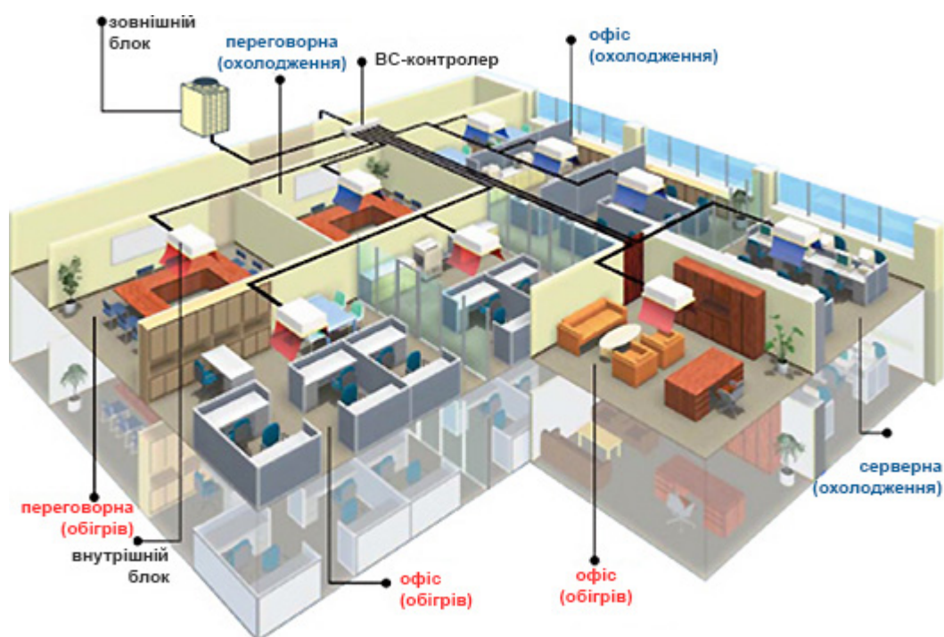
Рис. 6.5 Робота двотрубної VRF системи паралельно у двох режимах
