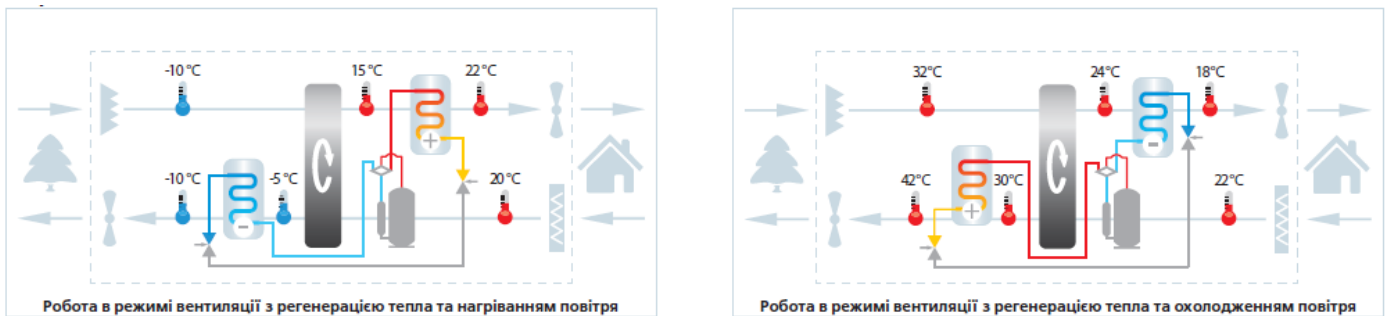
Рис.1.5. Схематичне зображення принципу роботи припливно – витяжної установки з тепловим насосом в двох режимах роботи
