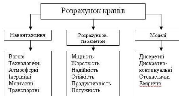
Рис. 3. Структурна схема послідовності розрахунку автокранів
