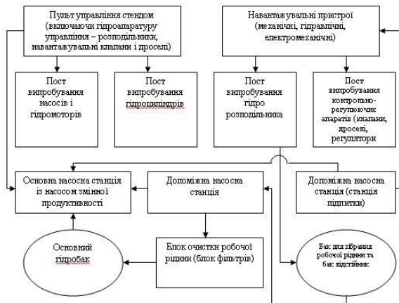
Рис. 4. Блок-схема універсального станда для діагностики кранів
