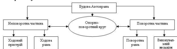
Рис. 1. Структурна схема автокрана
