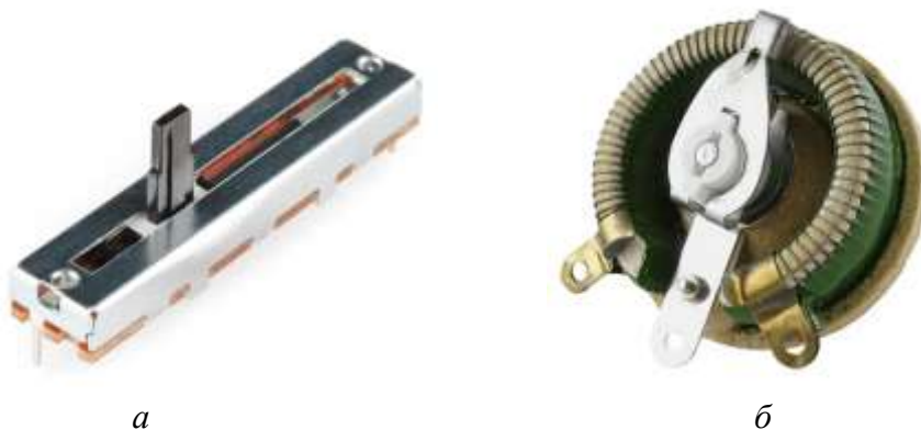
Рис. 5.2. Лінійний (а) та кутовий (б) потенціометри
