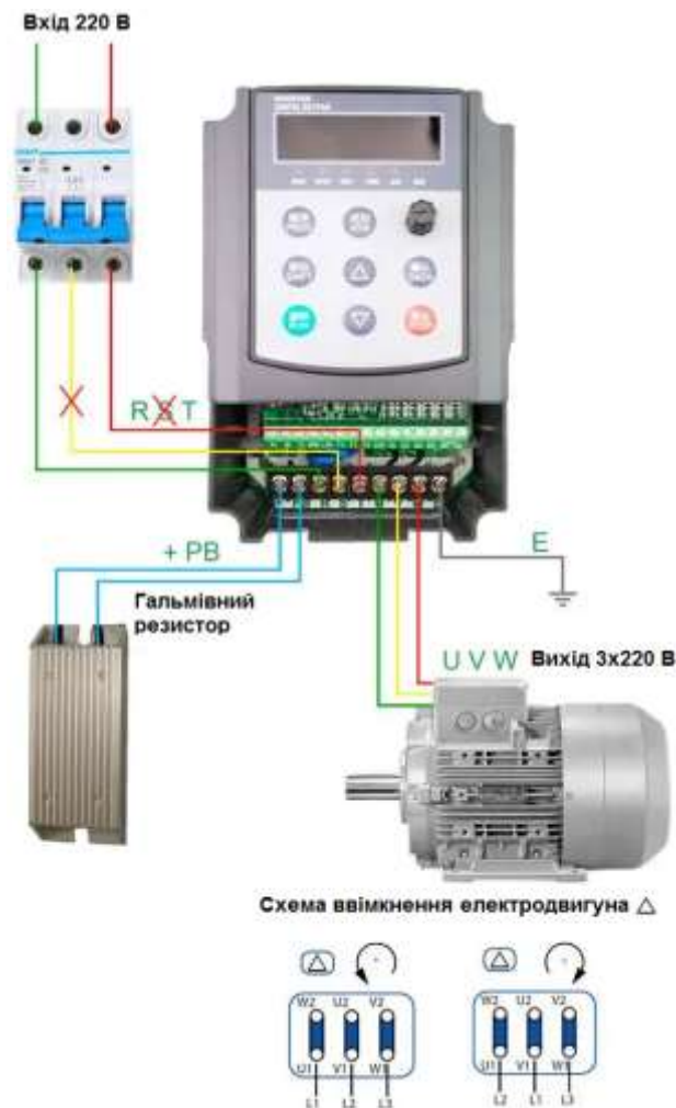
Рис. 2.18. Схема під'єднання електродвигуна до частотного перетворювача
