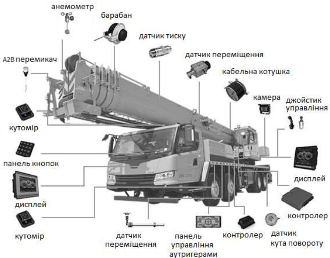
Рис. 1.11. Мехатронна система автомобільного крана
