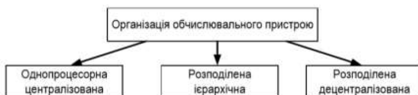
Рис. 6.1. Способи організації обчислювального пристрою системи комп'ютерного керування
