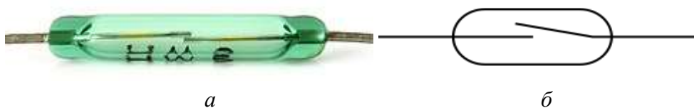
Рис. 5.19. Геркон: а – вигляд; б – схематичне позначення
