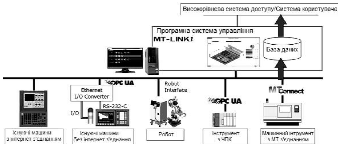
Рис. 6.8. Комунікація на рівні системи MT-LINKi: OPC Unified Architecture (OPC) – специфікація, що визначає передавання даних в промислових мережах і взаємодію пристроїв в цих мережах
