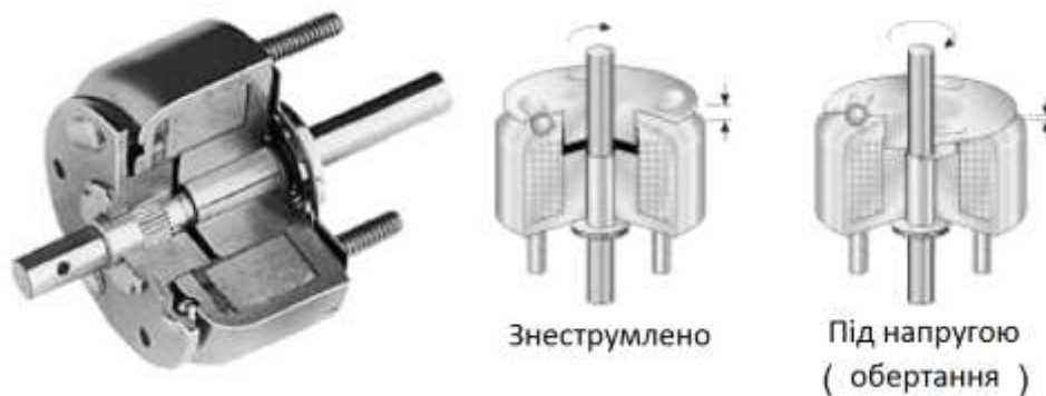
Рис. 2.11. Загальний вигляд поворотного соленоїда
