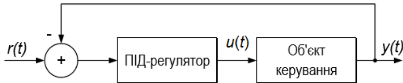
Рис. 8.1. Структура системи із застосуванням ПІД-регулятора
