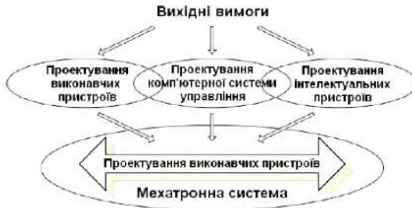
Рис. 3.4. Алгоритм паралельного проектування мехатронних систем
