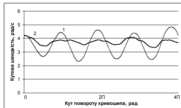
Рис. 2. Графіки зміни кутової швидкості приводного вала установки в холостому режимі з одним формувальним візком (1) та з двома візками (2)
