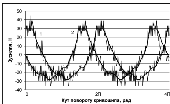
Рис. 7. Графіки зміни зусилля в шатунах на холостому ході
