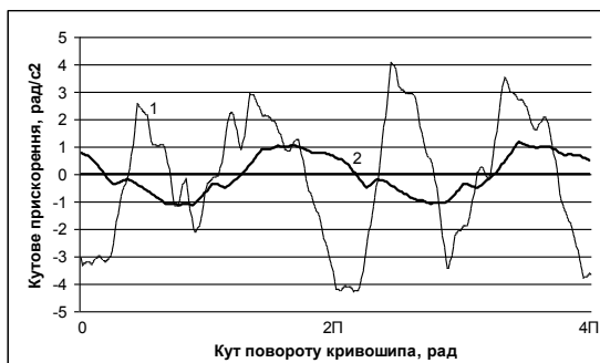
Рис. 5. Графіки зміни кутового прискорення привідного вала установки в робочому режимі з одним формувальним візком (1) та з двома візками (2)
