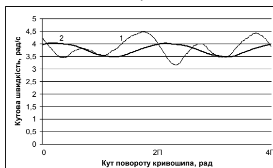
Рис. 4. Графіки зміни кутової швидкості привідного вала установки в робочому режимі з одним формувальним візком (1) та з двома візками (2)
