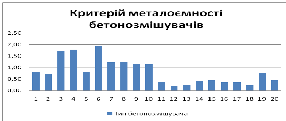
Рис. 2. Гістограми зміни критеріїв металоємності бетонозмішувачів різних типів.
