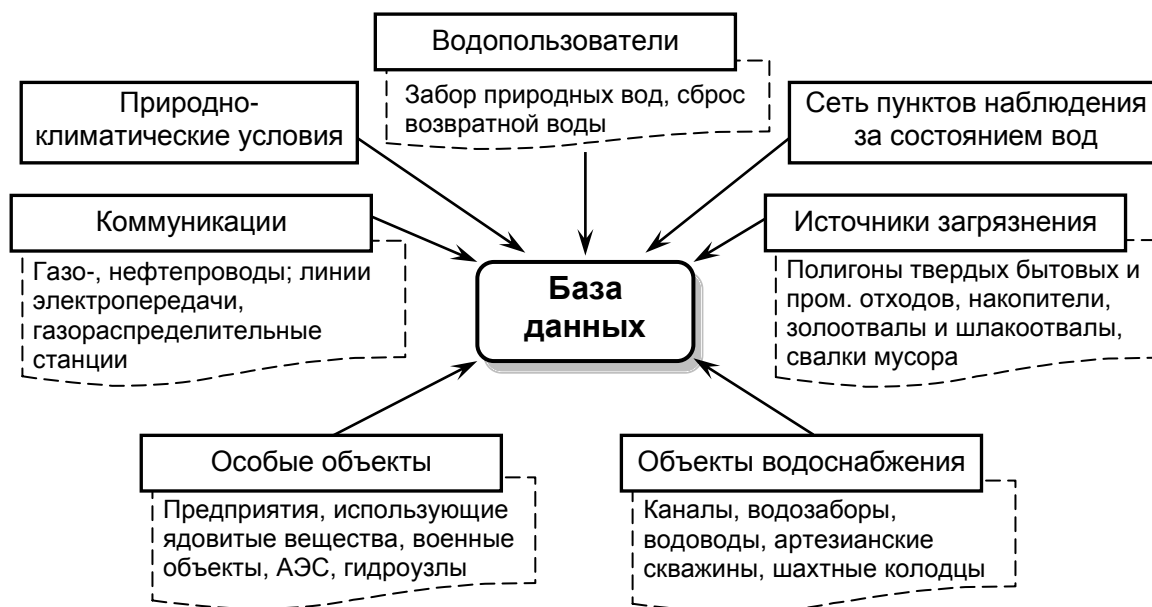
Рис. 4. Структура основных тематических слоев ГИС-технологий ЭБВ
