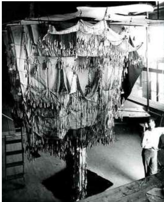
Рис. 4. Стереостатичний макет, створений Антоніо Гауді для розрахунку склепінь церкви в колонії Гуель (Colònia Güell), 1898 рік
