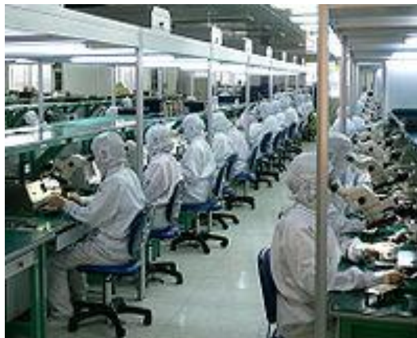
Рис. 1. Виробнича лінія у чистому приміщенні для потреб мікроелектроніки
