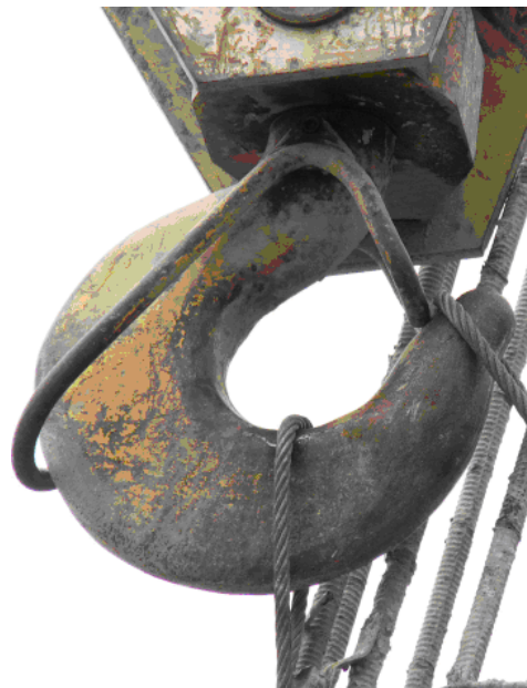
Рис. 1. Вихід стропа із гака крана КС- 6476
