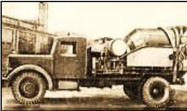
Рис.12. Перший вітчизняний автобетонозмішувач С-224 з автономним двигуном на базі ЯАЗ-200 (40-і роки ХХ-го ст.)
