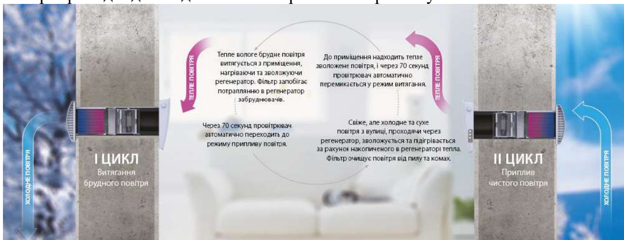
Рис. 1. Принцип роботи провітрювача Vents Twin Fresh [1]
