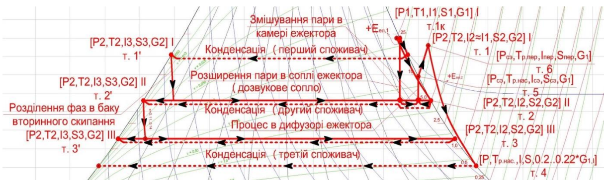
Рис. 2.7. Фрагмент TS-діаграми води та водяної пари. Характерні термодинамічні процеси послідовної схеми паропостачання промислового підприємства з використанням динамічного потенціалу перегрітої пари вторинного скипання
