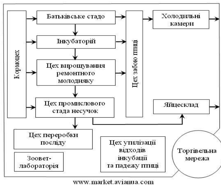
Рис. 3.1.1. Технологічна схема виробництва м'яса курчат – бройлерів
