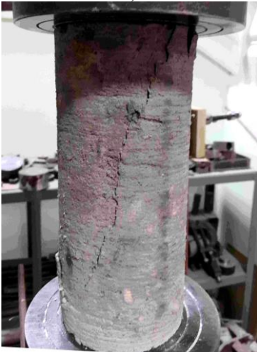
Рис. 2. Характер руйнування зразка керну ГЦЕ під час (а) і після (б) випробувань на стиск: 1 - № 1 ГЦЕ № 1; 2 - № 4 ГЦЕ № 2; 3 - № 8 ГЦЕ № 2
