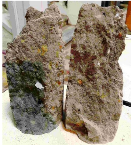
Рис. 2. Характер руйнування зразка керну ГЦЕ під час (а) і після (б) випробувань на стиск: 1 - № 1 ГЦЕ № 1; 2 - № 4 ГЦЕ № 2; 3 - № 8 ГЦЕ № 2
