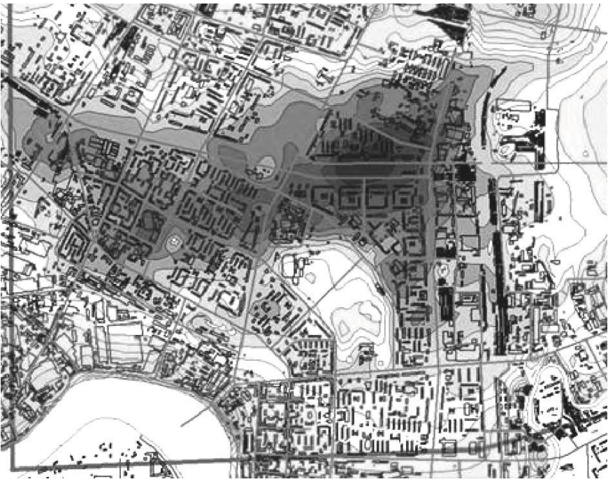
Рис.1. Моделювання зон підтоплення з використанням ГІС-технологій.
