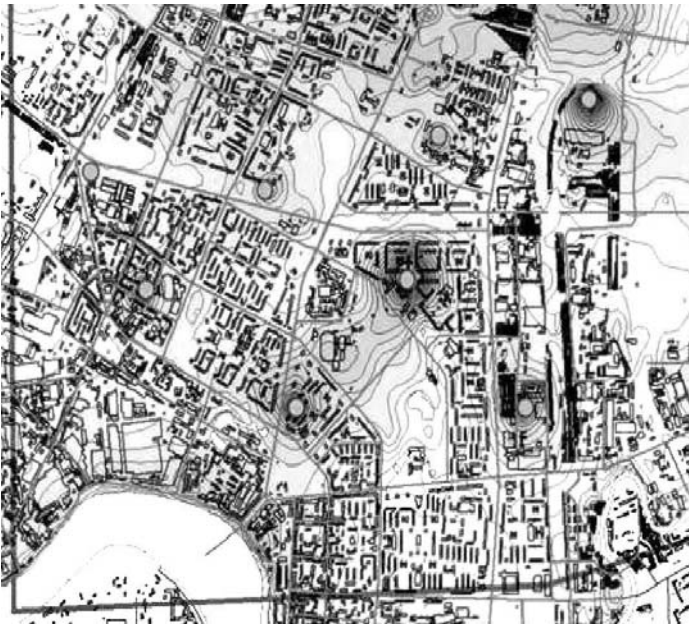
Рис.2. Моделювання роботи вертикального дренажу з використанням ГІС-технологій.
