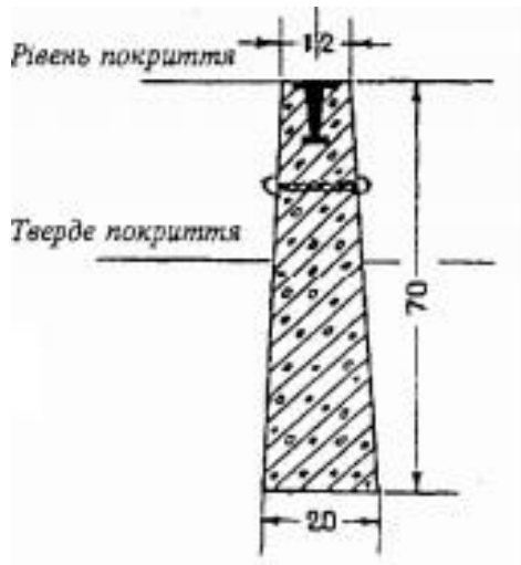
Рис.2.10. Центр полігонометрії 4 класу, 1 та 2 розрядів типу У-15
