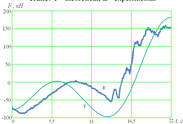
Рис. 7. Графік зміни зусилля в зубчастій рейці реального крана: T – теоретичний; E - експериментальний
