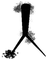
Рисунок 3 – Наличие случайных помех на изображении трещины
