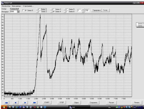
Рис. 3. Осцилограми зміни дотичної сили опору ґрунту різанню
