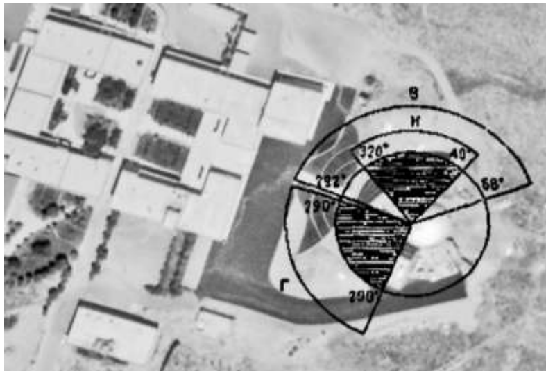
Рис.4. Заштрихованные фрагменты показывают те участки фасада, которые находятся в зоне перегрева.
