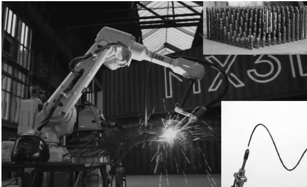
Мал. 4. Зварювальний газовий напівавтомат для 3D друку металевих конструкцій «MX3D», Амстердам, Нідерланди.
