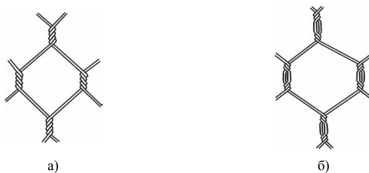
Рис. 2. Схема чарунок габіонної сітки: а) з подвійною звивкою; б) з подвійною скруткою з О-подібним отвором
