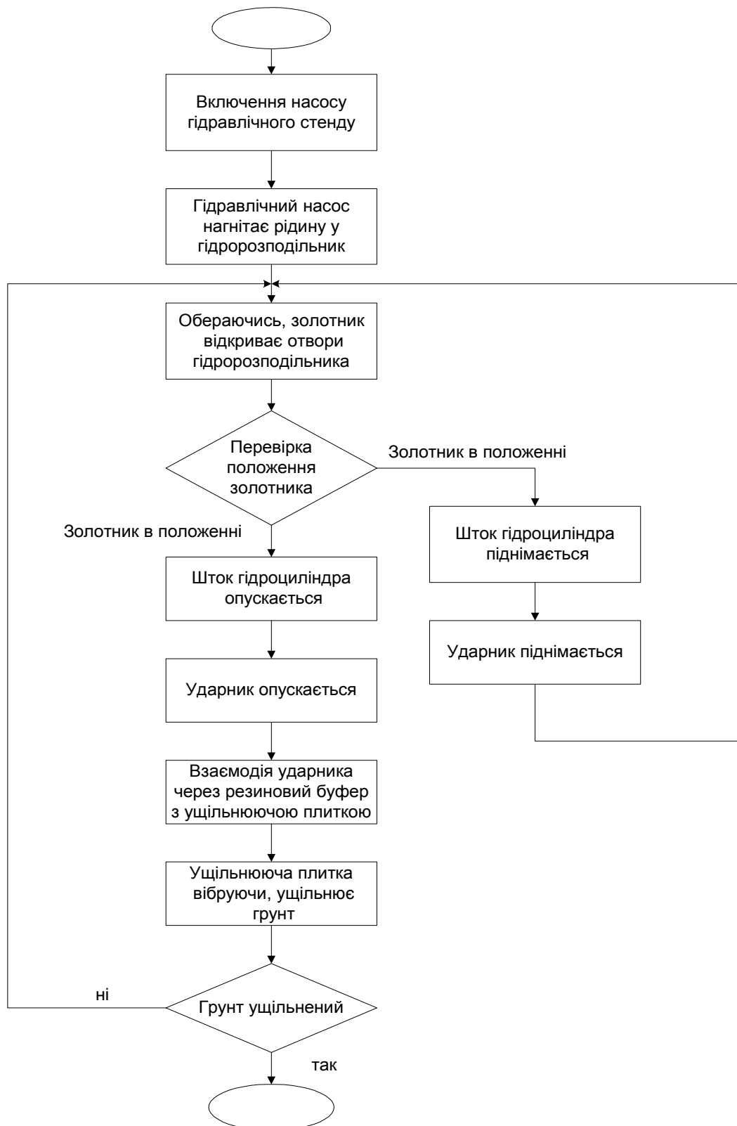
Рис. 6. Алгоритм роботи гідравлічної трамбівки в процесі ущільнення ґрунту
