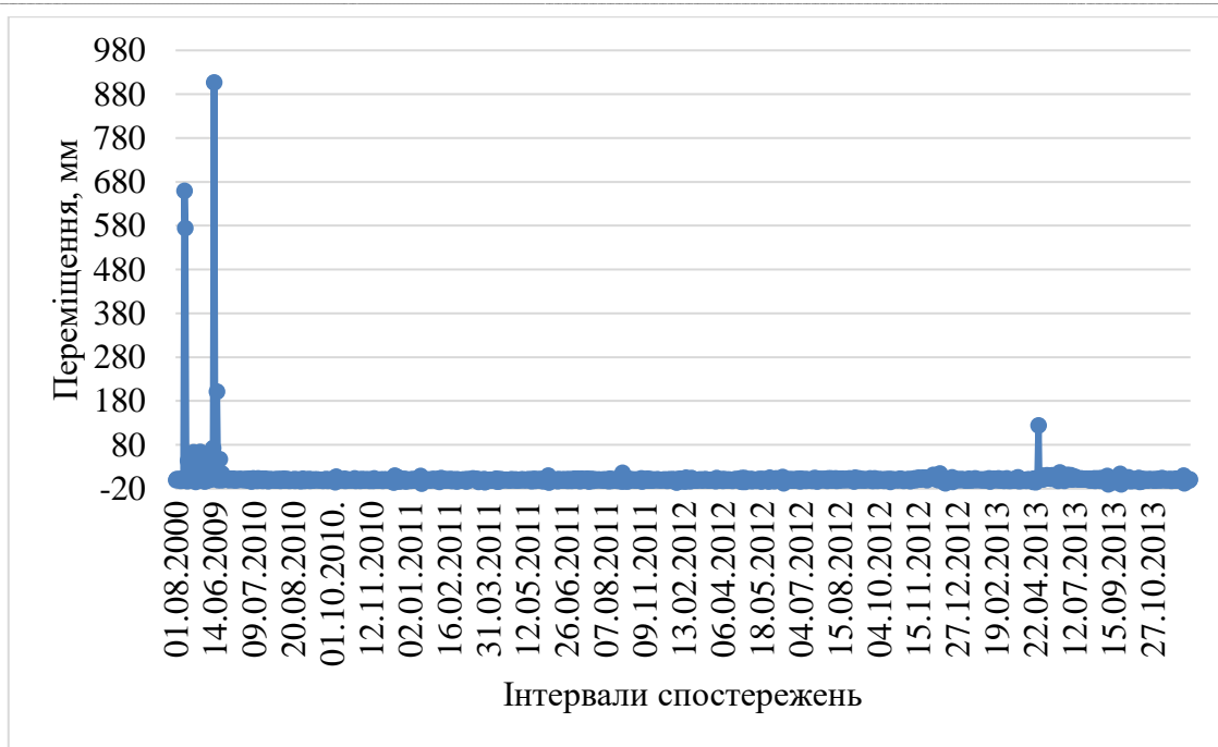
Рис. 2. Виміряні вертикальні переміщення для станції МС
