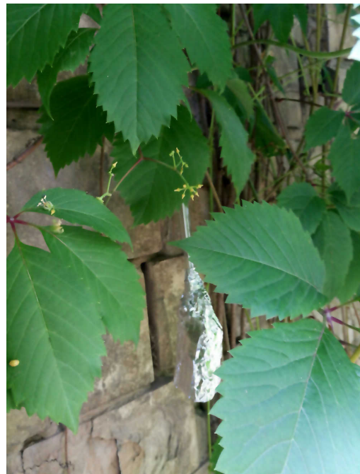
Рис.2. Розташування термометра для вимірювання температури під рослинним шаром вертикального озеленення з винограду дикого ( Parthenocissus )
