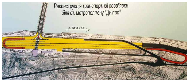
Рис. 8. Перетин на підході до мосту Метро у станції метрополітену «Дніпро» в Києві після реконструкції
